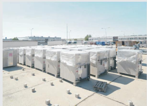
Prefabrikované kúpeľne vyrábané našou spoločnosťou sú prefabrikované produkty najvyššej kvality, kompletne vybavené zvoleným sanitárnym vybavením ako i horizontálnymi a vertikálnymi inštaláciami. Samonosná konštrukcia kúpeľňovej bunky splňa všetky stavebno - fyzikálne požiadavky a tiež ponúka široké možnosti riešenia sanitárneho priestoru.
