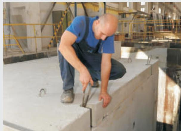
**PODLAHA** je zhotovená z vystuženého betónu s minimálnou hrúbkou 50 mm, pri zapracovanom spáde až do 70 mm, s podlahovým kúrením až 90 mm. Podlaha sa vodotesne spojí s bunkou a vytvorí jeden celok.
